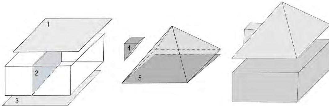
1 Deckplatte 2 Stützwand 3 Bodenplatte 4 Seitenfenster 5 Unterseite Dach
