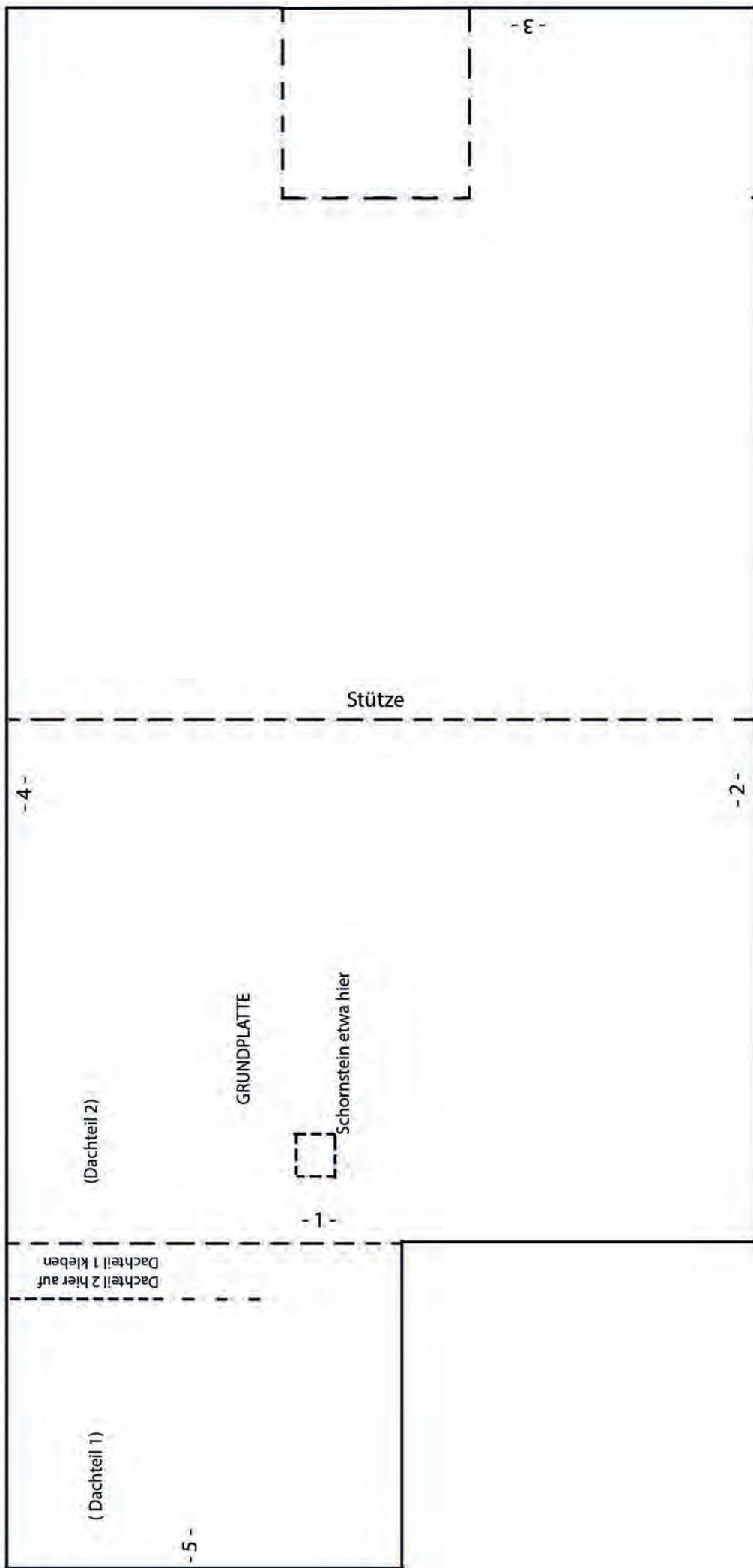
Erst die Giebelwände fertigstellen, dann die Wände in der gegebenen Reihenfolge um die Bodenplatte kleben, evtl. den Eingangsbereich einkleben, das Stützelement einbauen. Danach das Dach aufsetzen, zuerst das kleine Dach. Das große Dach evtl. auf einer Seite (- 4 -) so knicken, dass es gut passt, zum Schluss den Schornstein aufkleben.
